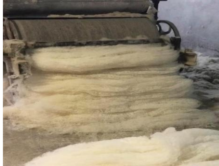
Görsel 9. Yün çırpma makinesinde yünün işlem gören yün (Kılıç Karatay,2025).
