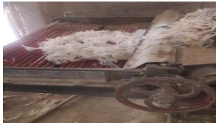
Görsel 10. Yünlerin söme olmak üzere tarak makinesine verilme işlemi (Kılıç Karatay,2020, s: 182).
